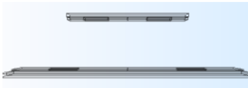
图5. 线圈耦合机构xz面二维模型图 (含平板磁芯)
