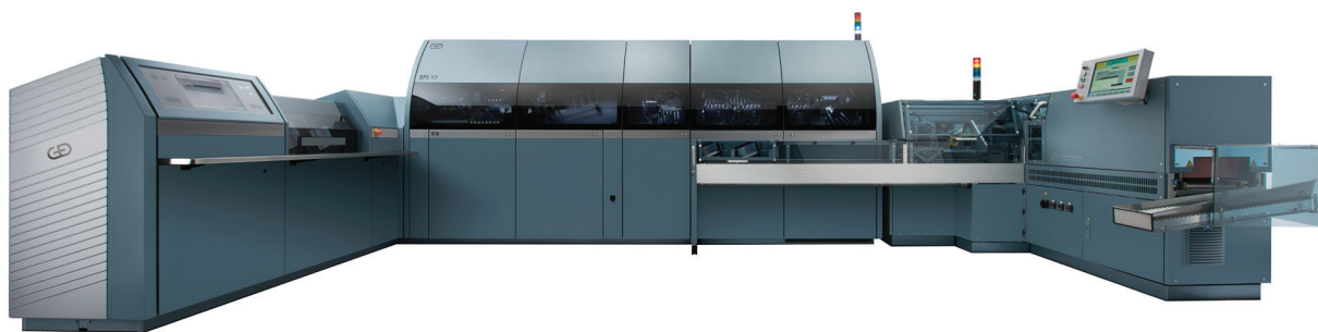
Рис. 1. BPS X9, самая быстрая система обработки банкнот в мире, может обрабатывать 44 банкноты в секунду. В час через нее проходит более 150 тысяч банкнот. Центральный модуль имеет размеры 1,9 м × 5,7 м.
